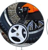
Die Stützräder können gewechselt werden, ohne das Hinterrad zu demontieren.
