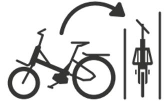
Mit eingeklappten Pedalen und eingeschlagenem Lenker (max. 25cm Breite) passt das MOCA in jeden Aufzug, Hausflur oder die schmalste Garagennische.
