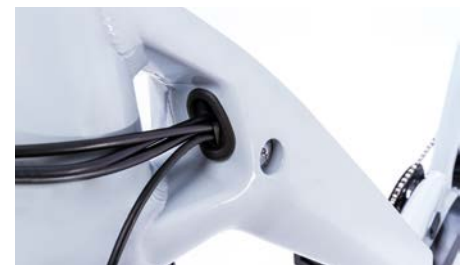
Für eine aufgeräumte Optik werden die Züge im Unterrohr verlegt.
