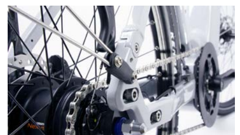
Verschiebbare Ausfallenden, um die Kette perfekt zu spannen.
