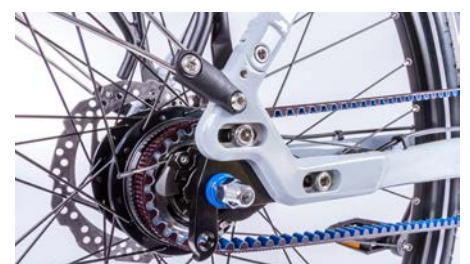
Der Hinterbau erlaubt die Montage eines Riemenantriebs.
