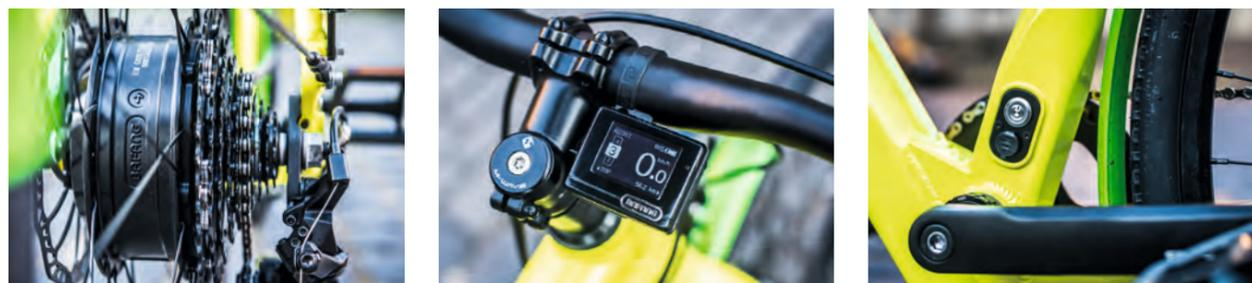
Angetrieben wird unser Light-E-Bike von einem kompakten und kraftvollen Bafang Nabenmotor, der sich unauffällig in die schlanke Erscheinung einfügt.
