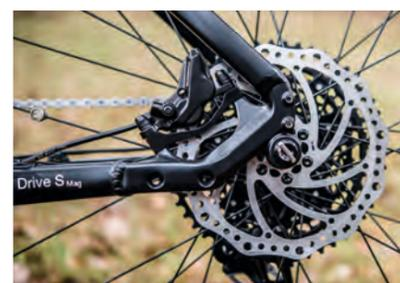
Hohe Flexibilität: Hinterbau mit 12x148 mm Boost Steckachsen und für Reifenbreiten bis zu 29"x 2,4", bzw. 27,5"x 2,8".
