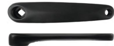
352603 Kurbelarm rechts, Aluminium, 170 mm (für Tretlager Art. 610502)
