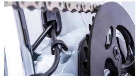
Der hintere Kabelauslass sorgt für eine cleane Optik.
