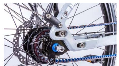
Der Hinterbau erlaubt die Montage eines Riemenantriebs.
