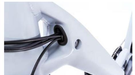
Für eine aufgeräumte Optik werden die Züge im Unterrohr verlegt.
