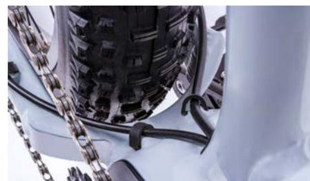
Eine spezielle Konstruktion erlaubt eine große Reifenbreite bei kurzem Hinterbau.
