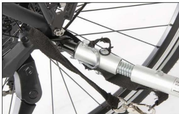
Um den Anhänger zu trennen, lösen Sie den Sicherungsstift und den Sicherheitsriemen. Um den Verbindungsbolzen zu demontieren, schrauben Sie die Mutter der Hinterradnabe wieder auf.
