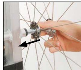
Um die Reifen auszubauen, heben Sie die hintere Seite des Anhängers hoch. Entsperren Sie die Schnellverriegelung mit einem einfachen Druck und ziehen Sie am Reifen.
