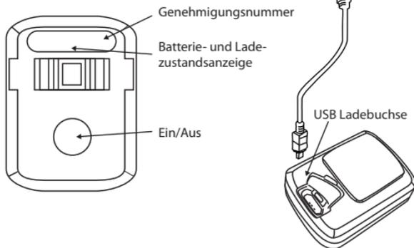
1. Bei Aufleuchten der grünen Batteriezustandsanzeige muss der Akku umgehend aufgeladen werden. Die Ladezustandsanzeige leuchtet während des Ladevorgangs rot und erlischt, wenn der Akku voll geladen ist. (Ladezeit ca. 2-3 Stunden)
