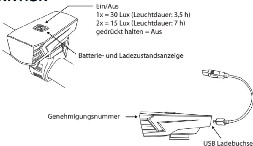
1. Bei Aufleuchten der roten Batteriezustandsanzeige muss der Akku umgehend aufgeladen werden. Die Ladezustandsanzeige leuchtet während des Ladevorgangs grün und erlischt, wenn der Akku voll geladen ist. Ladezeit: ca. 3 - 4 Stunden
