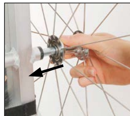
b) Achse in die Öffnung führen
