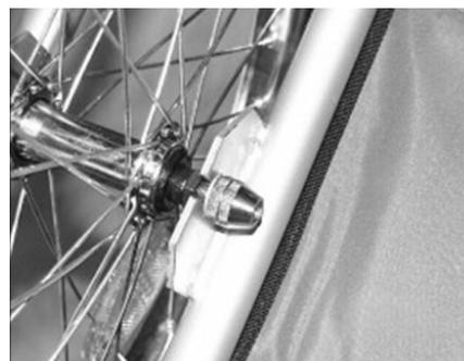
**Räder einsetzen:** Entfernen Sie die schwarzen Abdeckkappen von den Rädern.
