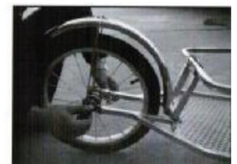
Befestigen Sie das Hinterrad am der Anhängergabel mit dem Schnellspannerbolzen.
